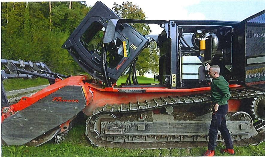
Die Kabine kann elektrisch abgeklappt werden, der Motorraum ist durch großzügig zu öffnende Klappen gut zu erreichen. Fotos: Biernath
