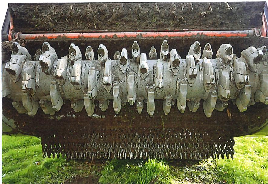
Das ergibt ein feineres Mulchgut: 68 Werkzeuge sitzen auf dem neuen Rotor. Die Kraft kommt vom Motor, geht über eine Turbokupplung, ein Kegelradgetriebe und Powerbänder an den Rotor.
